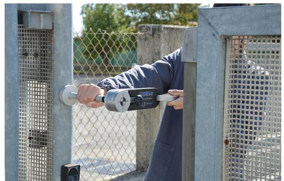
Daher, in unserem Fall, um die totale Einhaltung der EN12453:2017 sicherzustellen, wird nur die Kalibrierung des Geräts gefordert, um überprüfen, dass die Genauigkeit der Messung innerhalb der festgesetzten Grenzen ist, das heißt +/- 5% oder 10N (welche der höhere Abweichung ist).
