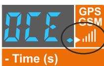
Pour vérifier l'état de la réception GSM et GPS, il est nécessaire d'afficher le **point indicateur**, situé à l'extrême droite de l'écran au symbole du signal GSM/GPS :
