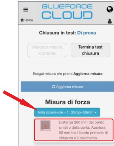
3) Vous pouvez maintenant prendre la mesure avec l'instrument au point choisi, puis appuyer sur **Actualiser mesure** pour l'afficher.
