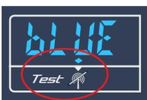
Die Funktion **rE-SEnd** kann auch im Falle eines **Übertragungsfehlers zum Server** verwendet werden. Die Warnung vor einer **nicht übertragenen** Messung wird durch den **leuchtenden Punkt** in der unteren linken Ecke des **Displays** beim Symbol "Nichtübertragung" angezeigt.
