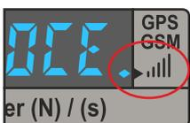
Um den Status des GSM- und GPS-Empfangs zu überprüfen, müssen Sie den **Anzeigepunkt** ganz rechts auf dem Display beim Symbol für das GSM/GPS-Signal sehen.
