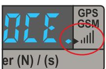
Para comprobar el estado de la recepción GSM y GPS, es necesario ver el **punto indicador**, situado en el extremo derecho de la pantalla en el símbolo de la señal GSM/GPS:
