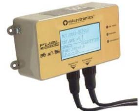
Oltre al conteggio del totale giri motore e del totale ore FuelLogger offre molte altre prestazioni utili per l'operatore, come la visualizzazione in tempo reale del regime di rotazione del motore, della tensione della batteria e delle ore giornaliere lavorate
