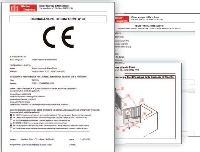
Oltre alla gestione delle misure, l'area Cloud permette di redigere tutti i **documenti necessari alla corretta certificazione** delle chiusure automatiche, come la Dichiarazione di Conformità CE, la Valutazione dei Rischi, i Verbali di Collaudo, nonché il Registro di Manutenzione.
