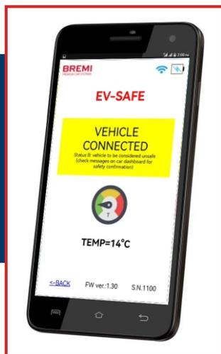
Grazie alla connessione WiFi Point-to-Point, l'utente può accedere direttamente al mini sito locale per visualizzare le informazioni sullo **stato di sicurezza del veicolo** senza bisogno di installare un App specifica!
