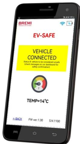
Grazie alla connessione WiFi Point-to-Point, l'utente può accedere direttamente al mini sito locale per visualizzare le informazioni sullo **stato di sicurezza del veicolo** senza bisogno di installare un App specifica!
