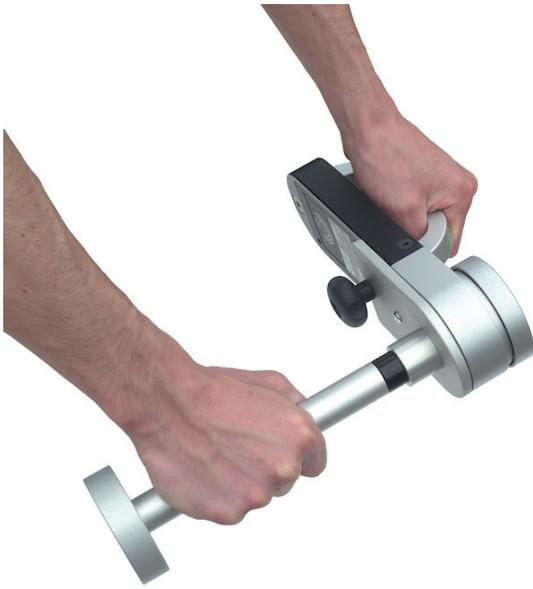
Das lineare Zubehör (Art.50V003), auch lineare Verlängerung genannt, ist ein mechanisches Zubehör, das sich fest an das Gerät befestigt und ermöglicht, Messungen (wie in der EN 12453 vorgeschrieben ist) auf vorgegebene Abstände: 30cm und 50cm zu machen.
