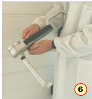
Tomando como referencia los puntos indicados por el software (véase la fig. 3), las mediciones siguientes se efectúan en las mismas posiciones pero a diferentes alturas, por lo tanto se efectúan tres pruebas en tres puntos (derecha, centro e izquierda) a una altura de 30 cm (véase la fig. 7), y después una medición única a una altura de 100 cm en la posición central (véase la fig 8).
