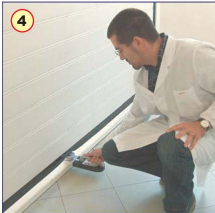
Pour chaque groupe de trois essais, il faut calculer la moyenne mathématique des paramètres mesurés (Force dynamique, Temps dynamique, Force statique et Force finale), le calcul est effectué automatiquement par le logiciel après que les essais ont été saisis aux points indiqués.
